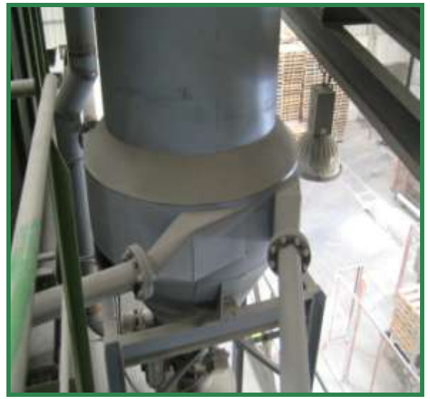
циклонный тангенциальный вход
